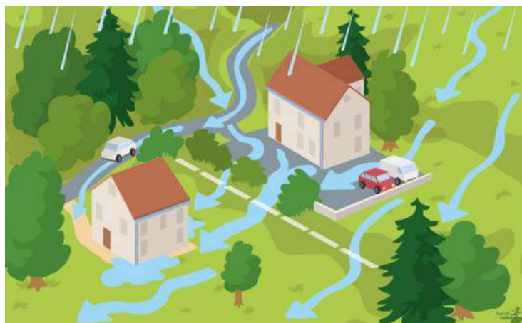
Schéma après goudronnage : aggravation de l'écoulement
